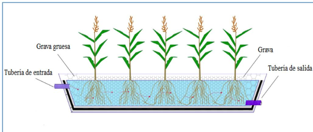
Figura 1. Humedal artificial de flujo subsuperficial horizontal (Sánchez, 2010)
