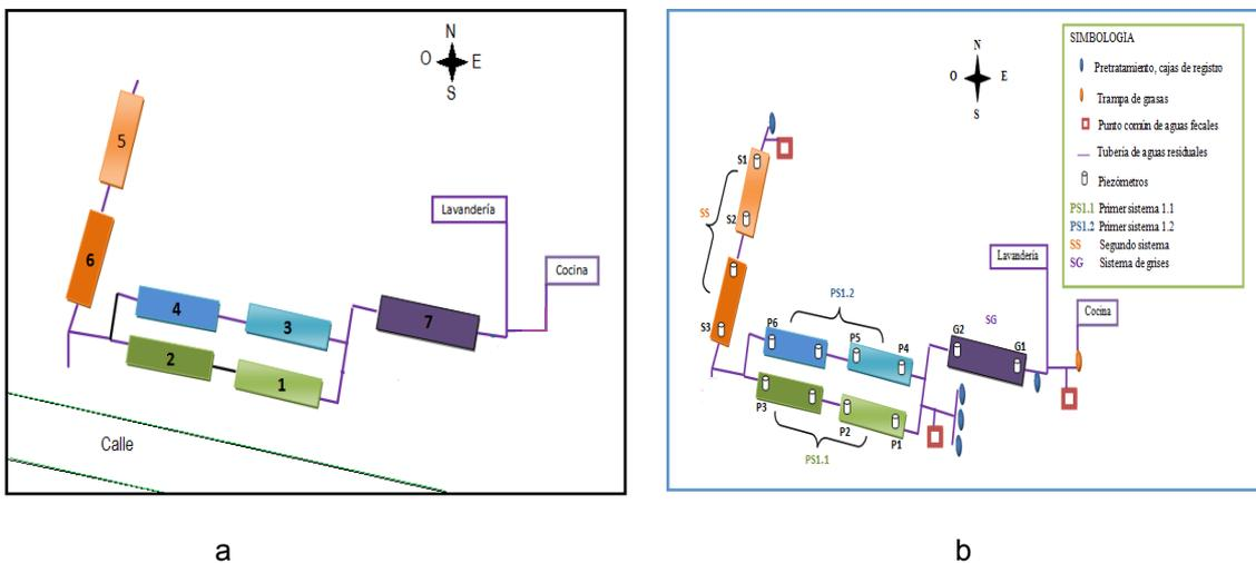
Figura 3. a) Esquema de distribución del sistema de humedales ubicado en el Hotel Diuwak, Costa Rica. b) Distribución de los puntos de muestreo.
