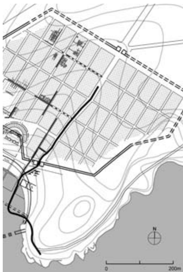
Fig. 92: Restitución de las insulae entorno al trazado urbano del gran colector aparecido bajo las calles Unió y Apodaca, la primera gran obra de infraestructura pública documentada en la nueva ciudad. Esta gran cloaca drenaba el recorrido de una antigua torrentera utilizada como vía de comunicación entre el castrum superior y la vaguada portuaria.
