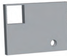
El producte final: Peça amb forat roscat i passant
