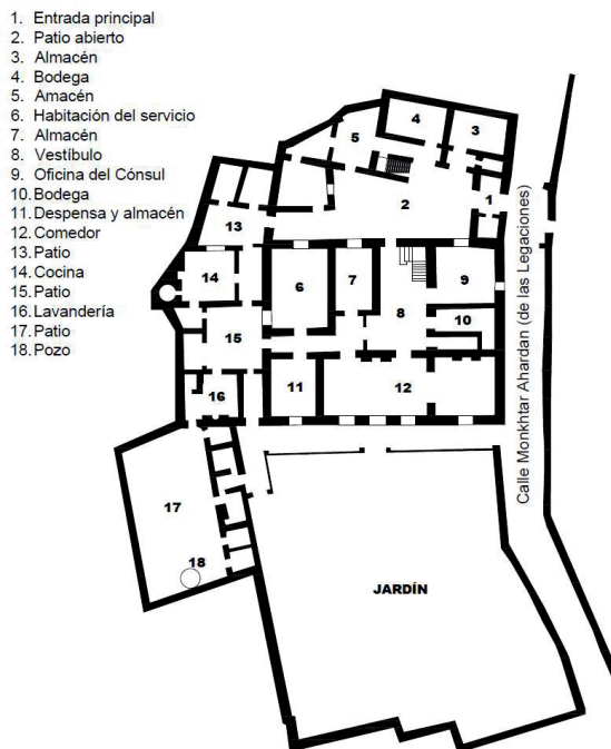
Figura 3. Planta baja del Consulado. Reproducción digital realizada por el autor a partir de un plano de 1887 (Works 10/53-3: 15).
