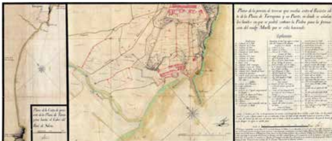
Fig. 25. Plano de la porción de terreno que media entre el recinto alto de la Plana de Tarragona y su Puerto, en donde se señalan los límites en que se podrá extraer la Piedra para la formación del nuevo Muelle que se está haciendo. 1800. 20-9-1800. Anónimo (Versión ayuntamiento según Gabriel).
