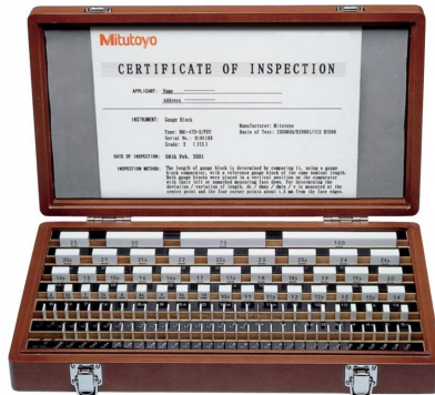
Figura 5.2: Blocs patró per al calibratge de sistemes de mesura de distància.
