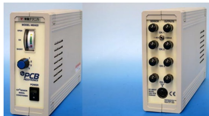
Figura 7.4: Mòdul d'acondicionament de senyal utilitzat en els experiments.
