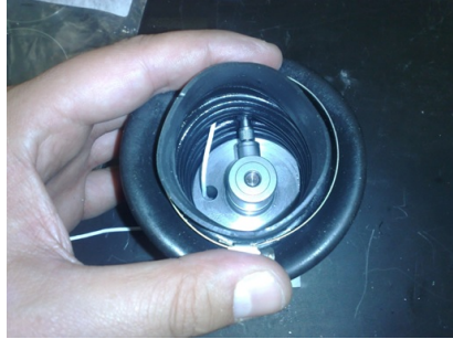
Figura 2.1: Una de les cel·les de càrrega piezoelèctrica utilitzada en els experiments.
