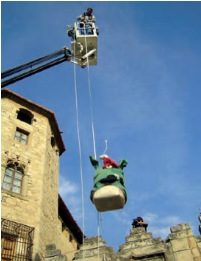
▲ Estudi de l'efectivitat de la pinya realitzat pel CAR de Sant Cugat, l'any 2005. Es va tirar un sac de set quilos des de diferents alçades sobre la pinya i es va mesurar, mitjançant una plataforma de càrregues, l'impacte resultant. (Fotos: CAR de Sant Cugat)
